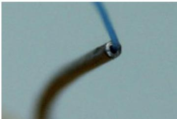
*Ago perforato con tecnica Laser-drilled*
