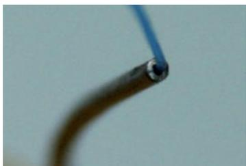
*Ago perforato con tecnica Laser-drilled*
