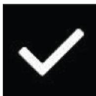
Il simbolo di **fine pulitura** ed, eventualmente, un segnale acustico (a seconda dell'impostazione dei parametri) indicano la fine della pulitura. Il display del tempo rimanente si spegne.
