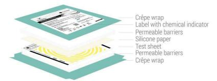
NOTA: i problemi relativi alla rimozione dell'aria o alla qualità del vapore verranno visualizzati come cambiamento di colore eterogeneo in marrone scuro/nero sul foglio di prova, con aree più chiare al centro o un cambiamento di colore non uniforme.
